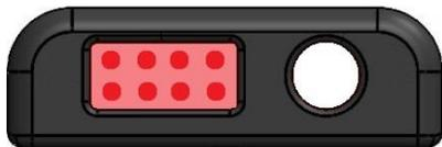
**Warnfeld 1 (orange) ohne Abbiegevorgang:** Bei Geschwindigkeiten von 0-30 km/h wird das Warnfeld 1 permanent überwacht. Eine Detektion eines Radfahrers oder Fußgängers wird über die Warn-LED (rot) in abgeschwächter Art kenntlich gemacht. Die Warn-LED bleibt so lange eingeschaltet, wie sich ein\*e Radfahrer\*in oder Fußgänger\*in im Warnfeld 1 aufhält. Statische Hindernisse werden nicht erkannt.
