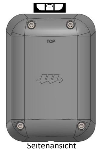
Die Montagefläche muss in der Winkeltoleranz von  $\pm 3^\circ$  parallel zur Fahrzeugaußenkante liegen.
